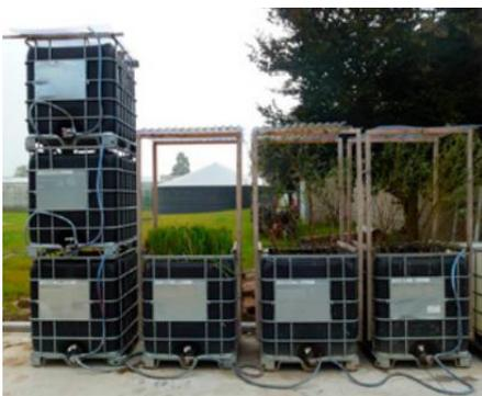
Biofiltre construit par un agriculteur. Source : Inagro
